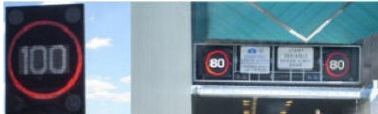
Slika 7. Znak ograničenja brzine primjenom VMS ( http://www.compusign.com.au/Product-VLSL.htm , 03.04.2015.)
