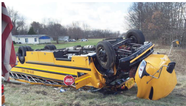
Slika 9. Potpuno narušavanje konstrukcije autobusa kod nezgode prevrtanja
