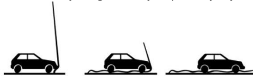
Slika 12. Primjer ponašanja stuba prilikom naleta vozila
