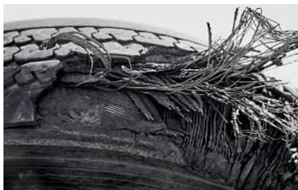
Slika 2. Loše stanje gazećeg sloja (odvajanje od osnovne stukture) kao jedan od uzroka saobraćajnih nezgoda
