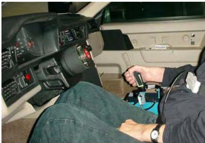
Слика 3. Систем управљања возила џојстиком (Peters, 2005)
