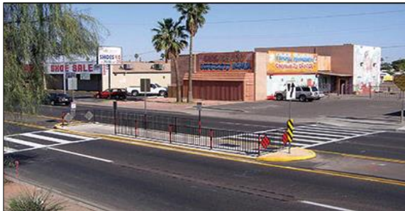
Слика 1. Пешачко острво са каналисаним пешачким токовима, употребом усмеравајућих ограда ( https://azdot.gov/ , 10.01.2021)
