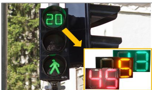
Слика 6. Уређај за одбројавање преосталог времена за пешачке са могућношћу приказивања заштитног времена
