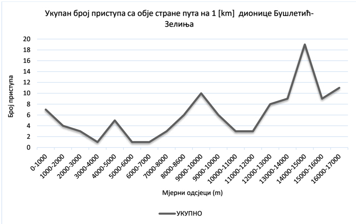
Дијаграм 1. Укупан број приступа са обје стране пута на 1 [km] дионице пута Бушлетић – Зелиња 3501
