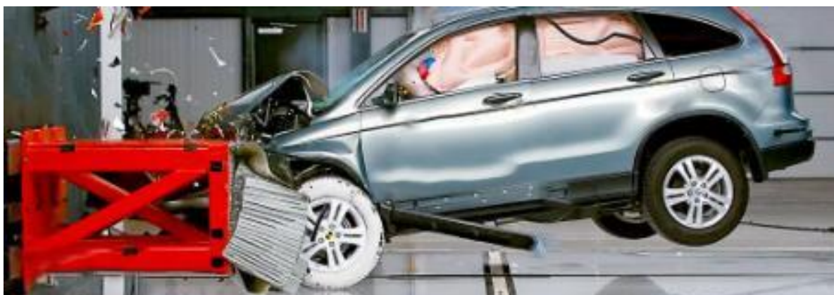
Slika 1. Oštećenje vozila u sudaru pri brzini od 64,37 km/h na testu sudara
