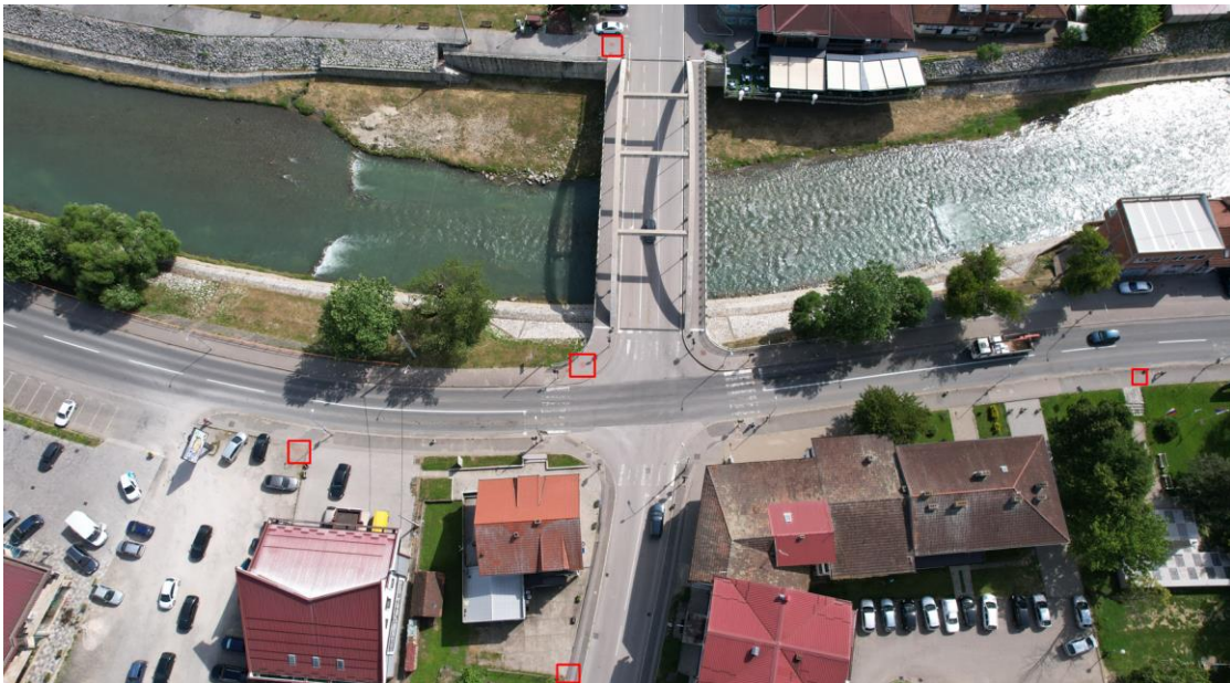
Слика 2. Локације земаљских контролних тачака на раскрсници улица Петра I Карађорђевића и Цара Лазара, општина Челинац
