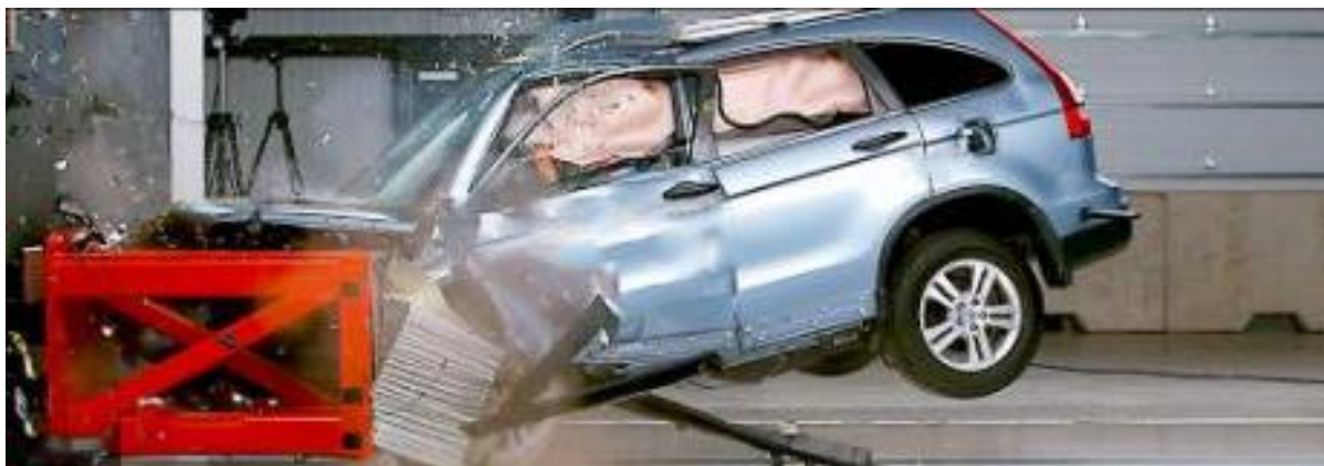
Slika 2. Oštećenje vozila u sudaru na testu-sudara pri brzini od 90,12 km/h
