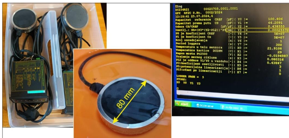
Слика 10. Приказ испоручених сонди за мјерење дебљине водног филма (лијево), приликом тестирања у условима потпуне потопљености (средина) и тест очитавања приликом суве сонде при чему се види висока резолуција (десно) – пројекат RESAFE
