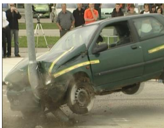
Slika 2. Zaustavljanje vozila sa brzinom naleta 46 km/h, trajanje udara 0,5 sekundi, usporenje -138 m/s 2
